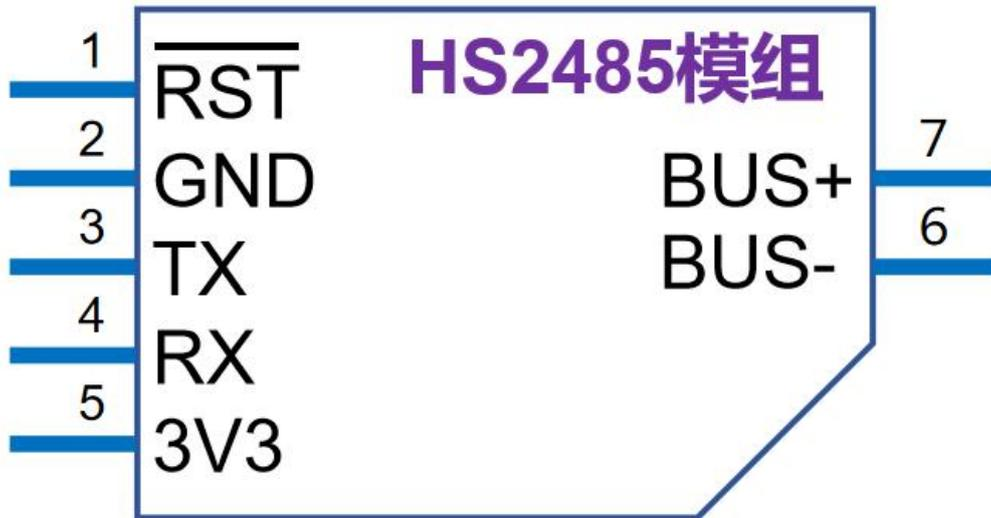
图 1 HS2485 端口示意图
